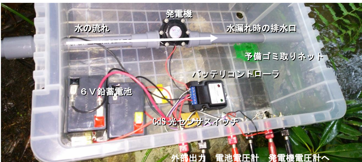
池まで水道管で水を引く 高低差4m 水道管は内径21mm 太目で丈夫なもの
